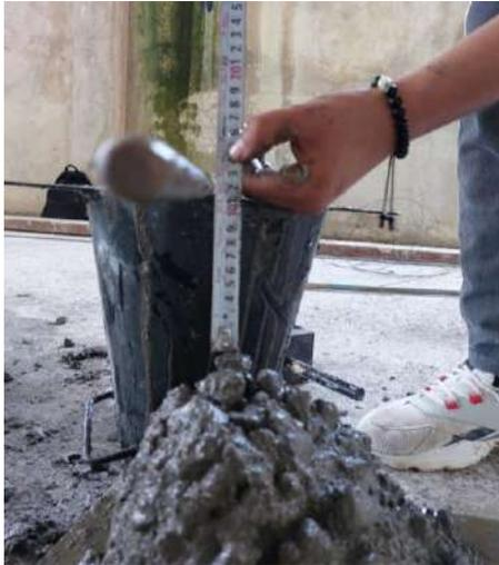
**Figura 3. Medición del revenimiento (autor propio).**
