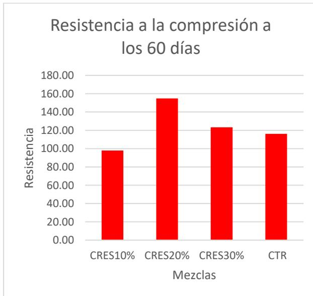
Figura 7. Resultados de resistencia a la compresión a los 60 días.
