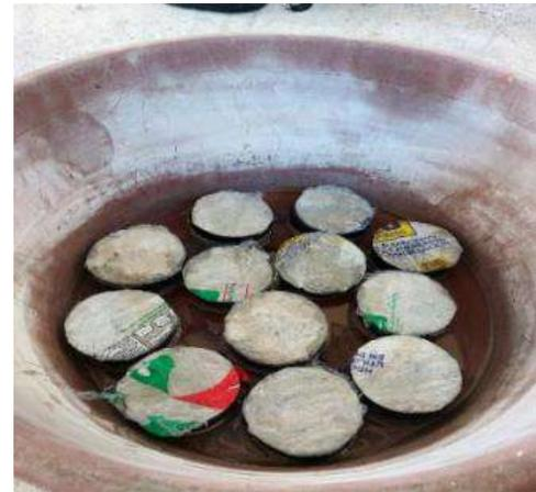
**Figura 5. Adsorción capilar (autor propio).**
