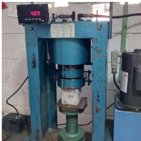
**Figura 4. Determinación de la resistencia a la compresión de un espécimen (autor propio).**
