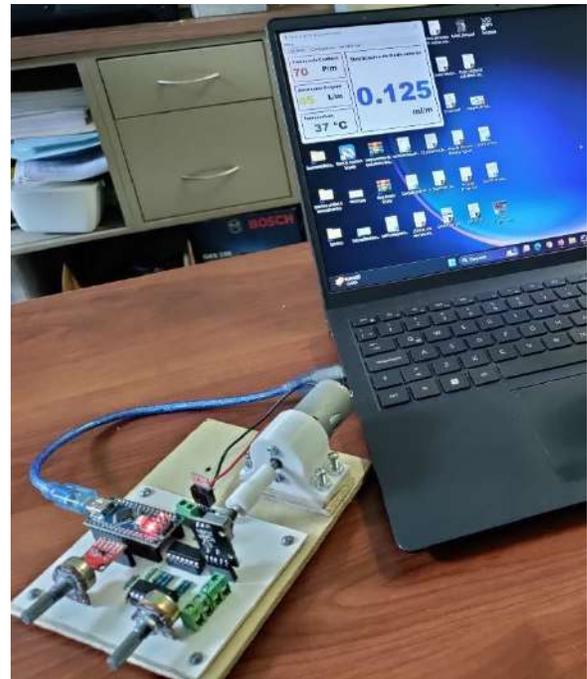
**Figura 11** muestra al prototipo conectado a la interfaz de control de la bomba de infusión. (Fuente: Elaboración propia 2023).
