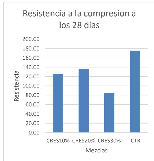
**Figura 6. Primer resultado de resistencia a la compresión a los 28 días.**
