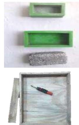
Figura 3. Molde de bloques de cemento y polvo, para construcción de las paredes del prototipo y base para el cimiento.
