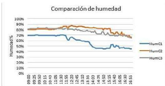
**Figura 9. Datos de comparación de la humedad entre los tres tipos de modelos implementados donde: HumC1 es “techo verde extensivo”, HumC2 “techo plano” y HumC3 “techo verde modular.”**
