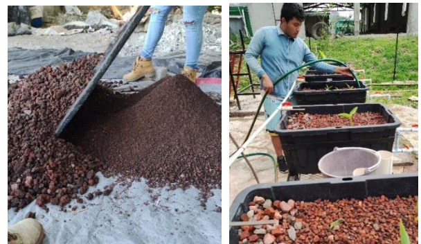
Ilustración 8 Selección del material filtrante, preparación e integración en geometría específica.
