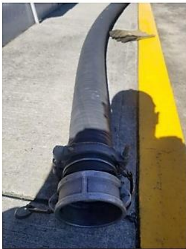
Ver figura 7. Manguera de descarga.
