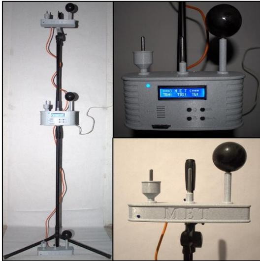
**Figura 7. Medidor de estrés térmico construido.**
