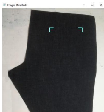
Figura 7 Muestra como resultado la forma y posición de las marcas que posteriormente se harán con el láser [Fuente propia 2020].
