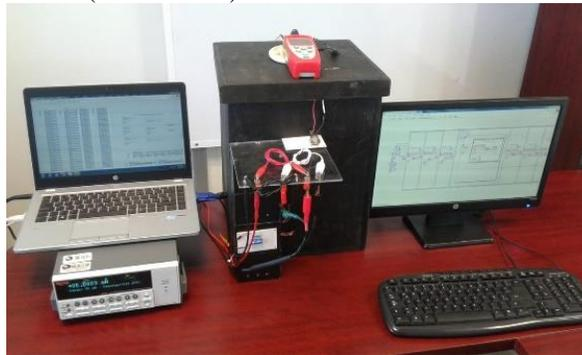
Figura 11: Sistema trazador y de análisis de curvas VI
