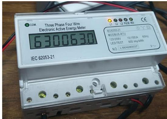
**Figura 1: Medidor de consumo de corriente eléctrica modelo IEC 672053. Dispositivo que cuenta con comunicación RS485 el cual debe de ser manipulado con un software que permita enviar y recibir comandos. Fuente: Creación Propia.**
