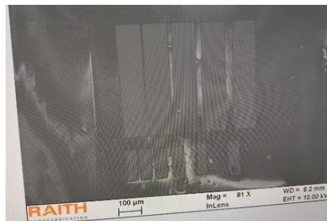
**Figura 14: Resultado del proceso de litografía electrónica, en el cual se aprecian las dos estructuras TLM, con sus bordes y separaciones de cada propuesta claramente definidos y sin defectos sobre la superficie de cada patrón diseñado.**
