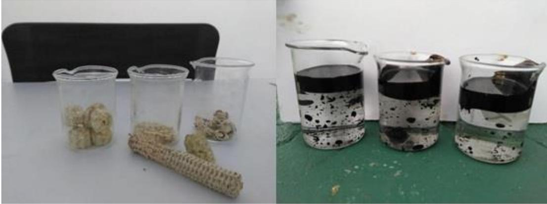
Figura 2 Muestras de raquis de maíz utilizadas y muestras de hidrocarburo utilizadas
