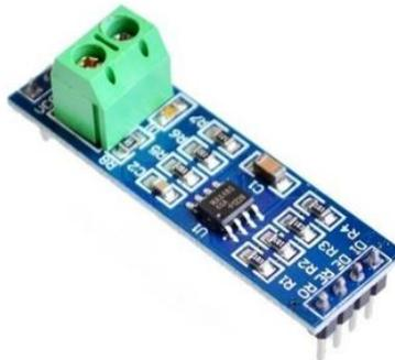
**Figura 5:** Modulo Serial Max485 RS485 a Rs232. El NodeMCU cuenta con comunicación serial, sin embargo se requiere del módulo Max485 con la finalidad de hacer uso del protocolo RS485 con los medidores proporcionados por la empresa. Fuente Construcción Propia
