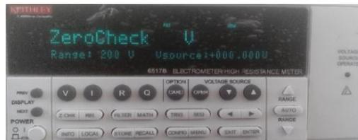
**Figura 2: Panel frontal del electrómetro Keithley 6517B**
