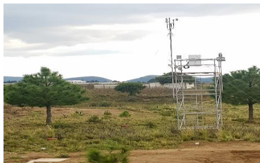
Figura 2: Estación anemométrica utilizada para la investigación
